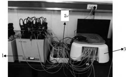
1. 水浴锅; 2. 脱除 CO 2 的百里酚酞试剂; 3. 气体计数装置
